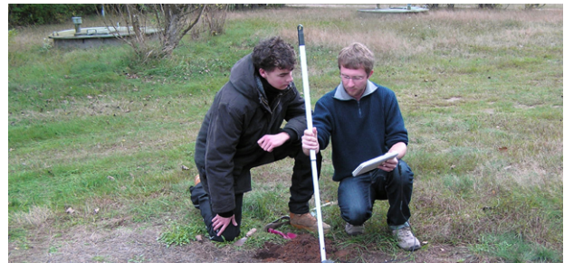
Messung im Boden, der mit Diesel kontaminiert ist
